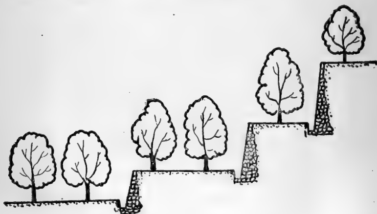
图12. 梯田台面内侧排水沟的设置
