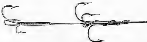
Fig. 312. Jardie's Hakensystem für die Schnappangel und lebenden Köderfisch.
