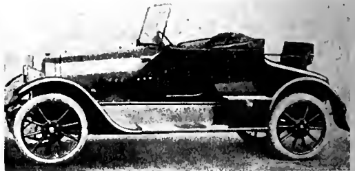
Uudenaikainen kaksi-istuiminen auto (istuimet vierkkäin) vara-istuimiseen (Protos-malli).
