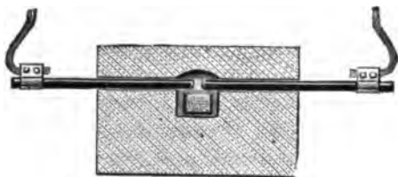
Fig. 1. — Schéma du four électrique Moissan.
