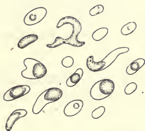
Fig. 17. — Inclusion liquide avec libelles de dimensions différentes.
