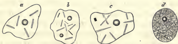
Fig. 4. — Inclusions vitreuses, plus ou moins dévitrifiées (englast).
