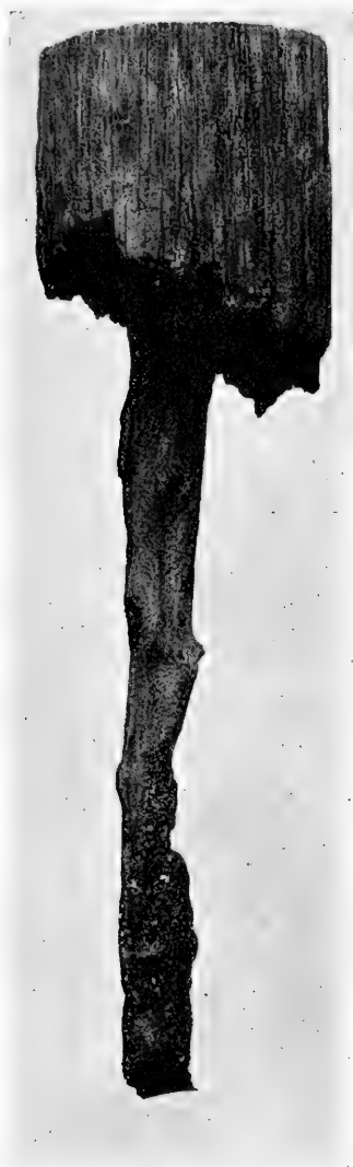
Fig. 283. — Piquet de Châtaignier rongé par le Valgus hemipterus L. 1/1 gr. nat. (orig. coll. Muséum, Paris).
