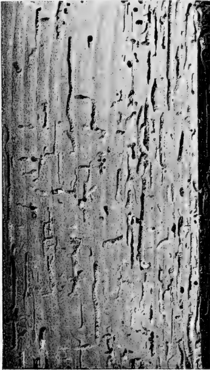
Fig. 77. — Poutre d'Épicéa ravagée par l' Anobium domesticum Fourc., 1/1 gr. nat. (orig. coll. Pauly, Munich).
