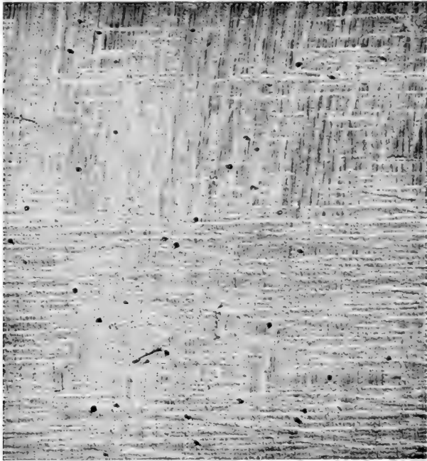
Fig. 216. — Poutre de Chêne ravagée par le Lymeriylon navale L. 3/4 gr. nat. (orig. coll. Muséum, Paris).
