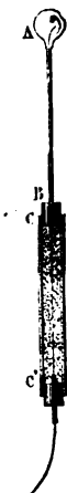
Fig. 199. en retirant toujours le tube AB jusqu'à ce que l'extrémité m de la petite colonne de mercure vint se montrer à l'orifice o .
