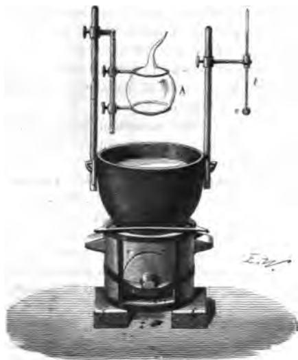
Fig. 230. — Détermination de la densité des vapeurs; procédé de M. Dumas.
