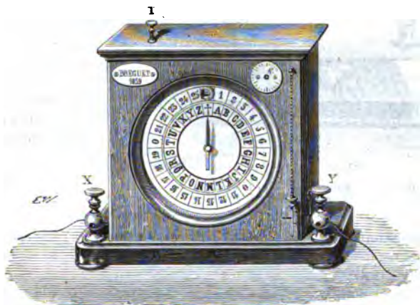
Fig. 452. — Récepteur du télégraphe à cadran.
