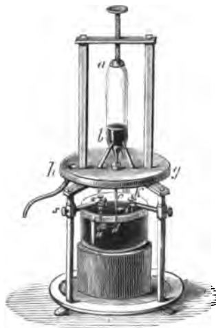
Fig. 207. — Thermomètre à air.
