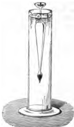
Fig. 91. — Aréomètre de Fahrenheit.
