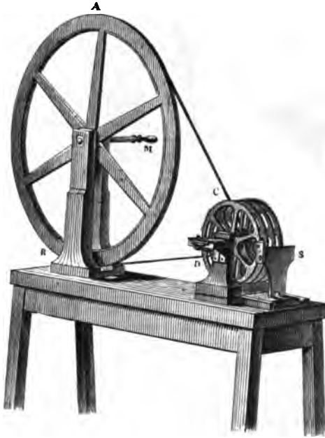
Fig. 507. — Roues dentées de Savart.
