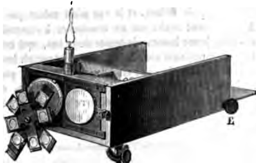
FIG. 412. — Optomètre binoculaire de Javal.
