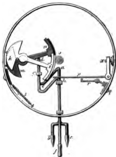
FIG. 367. — Tonomètre de Monnik, mécanisme.
