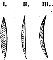
FIG. 414. — Formes diverses de lentilles sphériques convergentes (*).
