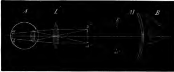
FIG. 269. — Théorie de l'ophthalmoscope, image renversée (*).
