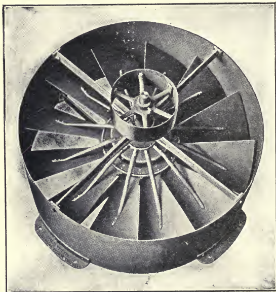
Fig. 62—Disk Fan with Flat Blades
