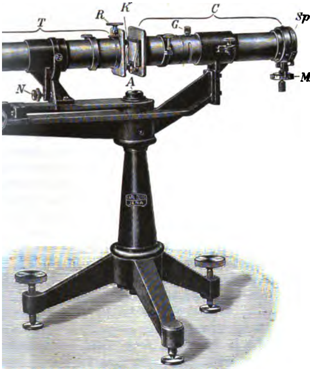
Gitterspektroskop (etwa \frac{1}{6} natürlicher Größe). Schutz zwischen R und K ist in der Figur weggelassen.
