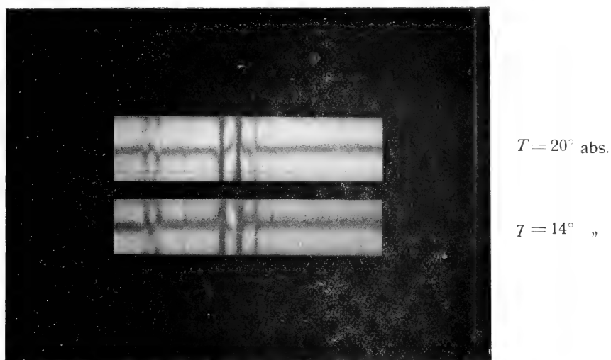
Fig. 5. Magnetische draaiing van het polarisatievlak. Xenotium, 2 de spectrum (ROWLAND), dikte 0,80 mM. veld 18000 Gauss (kwartgolfplaatje 90^\circ gedraaid in de eene ten opzichte van de andere).
