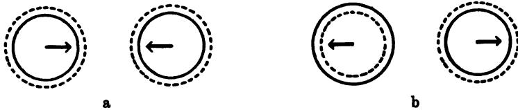
Fig. 2, a und b. Anziehung gleich pulsierender (a), Abstossung entgegengesetzt pulsierender Kugeln (b).
