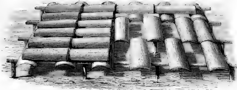
Fig. 3. Toit collecteur double.
