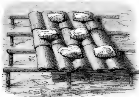
Fig. 2. Toit collecteur simple.
