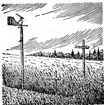
图 23 在黑麦地中，通风干湿球温度表，风速表和特列吉雅科夫风速计的装置(原图)
