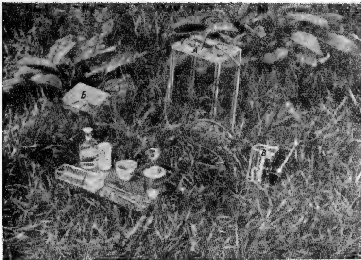
图 25 在放射性二氧化碳气流中测定光合作用强度的仪器 A——盛有放射性二氧化碳混合物的贮气柜；B——叶箱；B—— 泵；Г——放叶片固定器皿的托盘。
