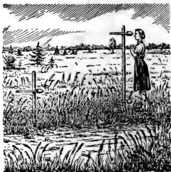
图 24 在草甸上，通风干湿球温度表和土温表的装置(原图)
