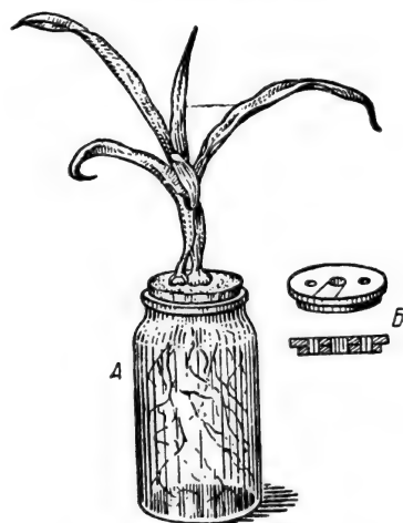
圖 2 水液培養器(A)和它的蓋子(B) (根據 Сказкин 等, 1953)
