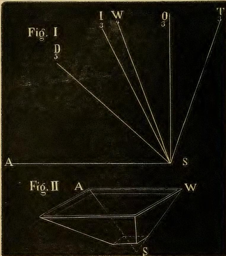
tene Spiegelstücke. In Fig. II. ist das zum Würfel gehörige Krystalloskop verkleinert gezeichnet. Die angebrachten Buchstaben entsprechen Fig. I. Zum Dodekaeder gehören 5 nach dem Winkel DSA geschnittene Spiegel u. s. w.
