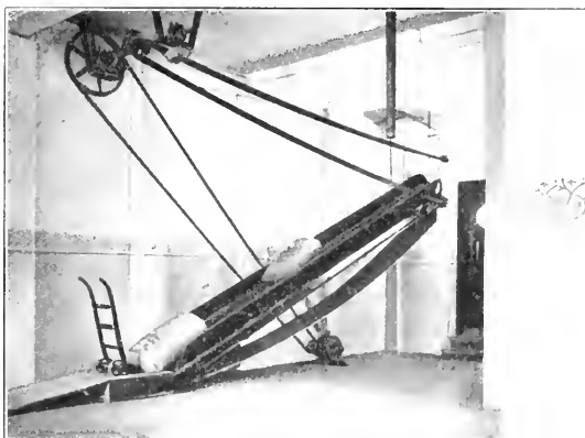
Fig. 27. Vorrichtung zum Aufladen der Säcke.
