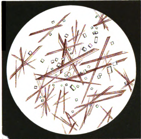
Cuprikaliumchlorid \text{Cu Cl}_2 \cdot \text{KCl} braune Nadeln und Chlorkalium \text{K Cl} weisse Wüfel entstanden durch Erhitzen v. \text{Cu Cl}_2 \cdot 2\text{K Cl} \cdot 2\text{H}_2\text{O}
