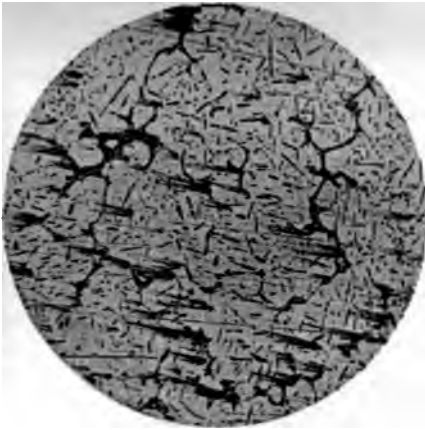
Fig. 1. 65% Fe + 35% Al 68fache Vergrößerung. Geätzt mit verdünnter Salzsäure.
