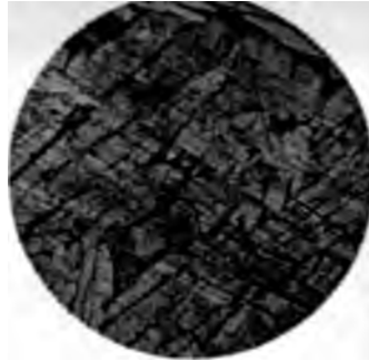
Fig. 2. 91,4% Cu + 8,6% Al. 68fache Vergrößerung. Geätzt mit konz. HNO 3 .
