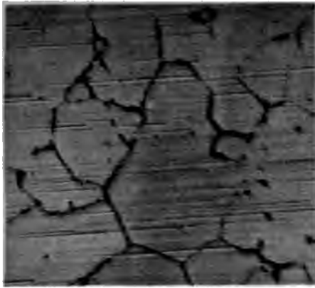
Fig. 1. 80% Ni, 20% Cr 180fache Vergrößerung.
