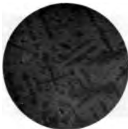
Fig. 3. 50% Cu + 50% Mn Schnell gekühlt, geätzt mit H_2SO_4 . 68fache Vergrößerung.
