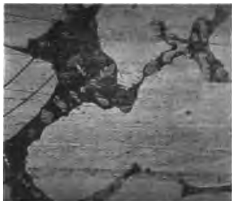
Fig. 6. 50,2 At.-Proz. Ni, 49,8 At.-Proz. Bi 180fache Vergrößerung. 60 St. exponiert.
