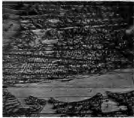
Fig. 2. 35% Ni, 65% Mg 180fache Vergrößerung.
