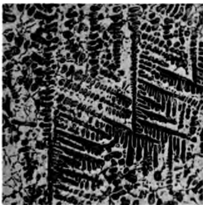
Fig. 1. 60 Gew.-Proz. Fe. 130fache Vergrößerung.
