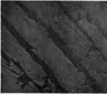
Fig. 7. 70% Ni, 30% Mg 180fache Vergrößerung.
