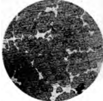
Fig. 4. 70% Cu + 30% Al. 68fache Vergröfß. Geätzt mit konz. HNO 3 . Nach 8 Stund. bei 600° langs. abgekühlt.
