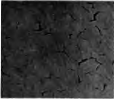
Fig. 1. 20% Cu + 80% Co Geätzt mit \text{NH}_3 + \text{H}_2\text{O}_2 . 100fache Vergrößerung.
