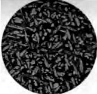
Fig. 1. 89% Cu + 11% Al. 68fache Vergrößerung. Geätzt mit konz. HNO 3 .
