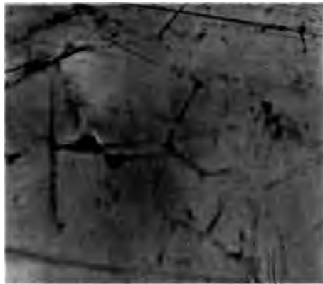
Fig. 8. 60 Gew.-Proz. Ni + 40 Gew.-Proz. Sn 180fache Vergrößerung. Schnell gekühlt.
