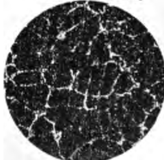
Fig. 8. 10% Cu + 90% Al. 68fache Vergrößerung. Geätzt mit konz. NaOH.
