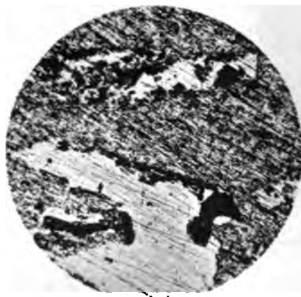
Fig. 6. 30% Fe + 70% Al 24fache Vergrößerung. Geätzt mit verdünnter Salzsäure.
