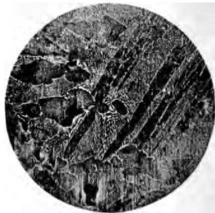
Fig. 4. 55% Fe + 45% Al 180fache Vergrößerung. Geätzt mit verdünnter Salzsäure.
