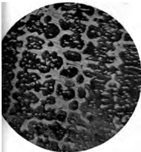
Fig. 1. 81,25% Ni + 18,75% Al. Nach 1 Stunde bei 1250° abgeschreckt, 68fache Vergrößerung. Geätzt mit Fe Cl 3 .
