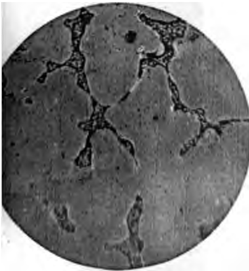
Fig. 3. 85% Co + 15% Al. 68fache Vergrößerung. Geätzt mit Fe Cl 3 .
