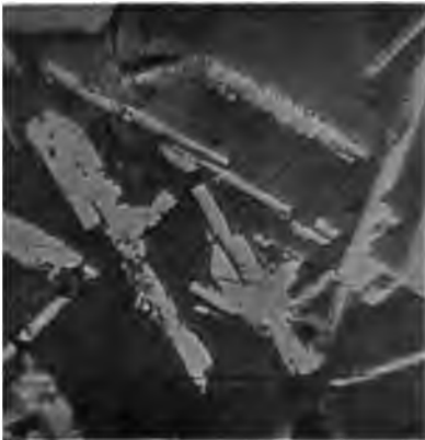
Fig. 5. 60% Ni, 40% Mg 180fache Vergrößerung.
