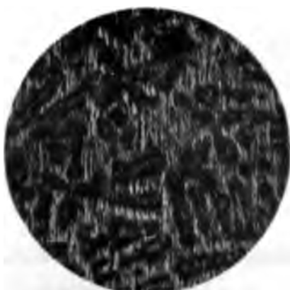
Fig. 4. 50% Cu + 50% Mn Schnell gekühlt, geätzt mit HNO_3 . 68fache Vergrößerung.
