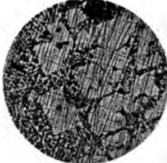
Fig. 6. 42% Cu + 58% Al. 68fache Vergrößerung. Geätzt mit konz. HNO 3 .
