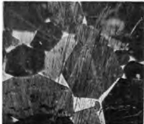
Fig. 4. 25 At.-Proz. Ni, 75 At.-Proz. Bi 180fache Vergrößerung. 60 St. exponiert.
