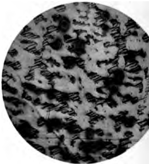
Fig. 2. 85% Ni + 15% Al. Bei gewöhnlichen Bedingungen abgekühlt. 68fache Vergrößerung. Geätzt mit Fe Cl 3 .
