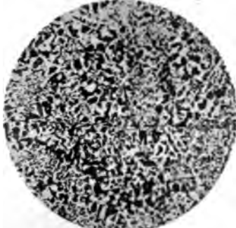
Fig. 7. 32,5% Cu + 67,5% Al. 68fache Vergrößerung. Geätzt mit konz. NaOH.
