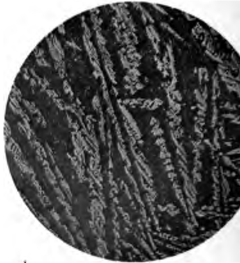
Fig. 4. 25% Ni + 75% Al. Bei gewöhnlichen Bedingungen abgekühlt. 21fache Vergrößerung. Geätzt mit Fe Cl 3 .
