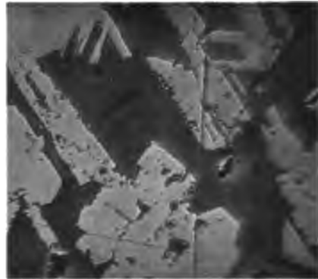
Fig. 6. 65% Ni, 35% Mg 180fache Vergrößerung.
