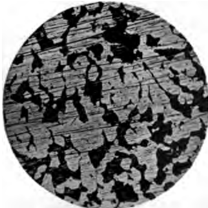
Fig. 5. 50% Fe + 50% Al 68fache Vergrößerung. Geätzt mit verdünnter Salzsäure.
