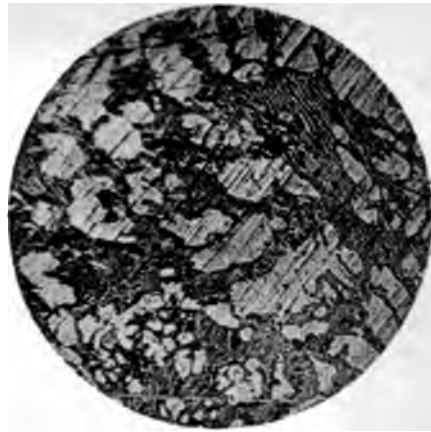
Fig. 2. 60% Fe + 40% Al 180fache Vergrößerung. Geätzt mit verdünnter Salzsäure.
