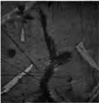
Fig. 3. 55% Ni, 45% Mg 180fache Vergrößerung.
