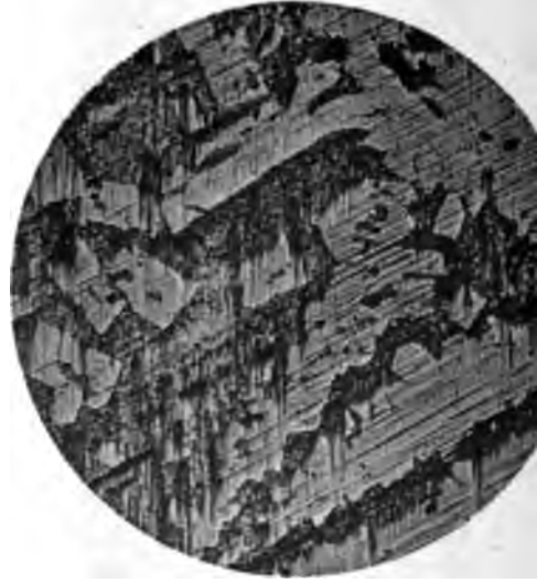
Fig. 4. 15% Co + 85% Al. Nach 20 Stunden bei 500°. Nicht geätzt. 21fache Vergrößerung.
