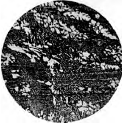
Fig. 3. 57,5% Fe + 42,5% Al 180fache Vergrößerung. Geätzt mit verdünnter Salzsäure.
