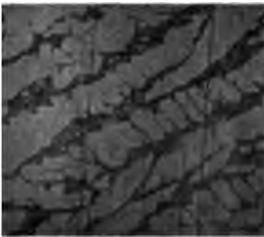
Fig. 5. 1,4 At.-Proz. Mg + 97,4 At.-Proz. Cu Geätzt mit HCl. 68fache Vergrößerung.
