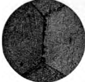
Fig. 3. 87,6% Cu + 12,4% Al. 68fache Vergrößerung. Geätzt mit konz. HNO 3 .
