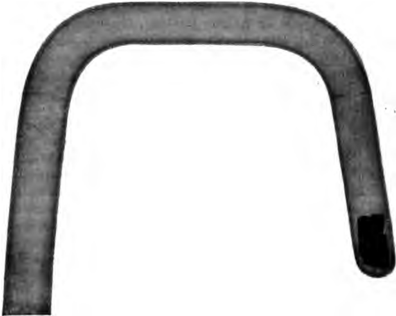
Fig. 4. Destillationsapparat aus Porzellan mit Zink beschickt.
