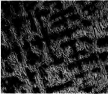
Fig. 3. Durch Zusammenschmelzen der Metalle Mo, 80% Fe. Geätzt mit Königswasser. 80fache Vergrößerung.
