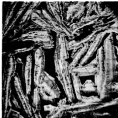
Fig. 3. 49,8 Atomproz. Sb — 50,2 Atomproz. Sn. 24fache Vergröß., geätzt mit alkoholischer FeCl 3 Lösung.
