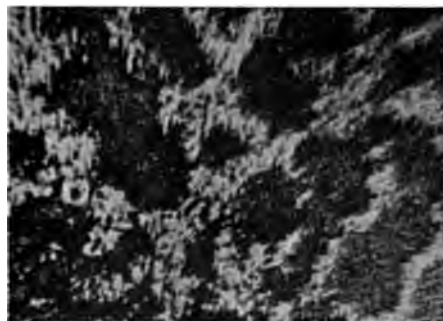
Fig. 5. Cr 30%, Fe 70% aluminothermisch dargestellt, dann umgeschmolzen. 180fache Vergrößerung.
