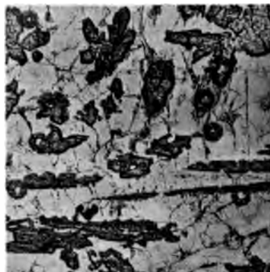
Fig. 4. 68,4 Atomproz. Mn — 31,6 Atomproz. Sn. 70fache Vergröß., geätzt mit \text{FeCl}_3 Lösung.
