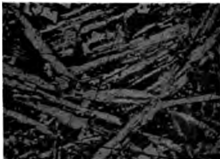
Fig. 13. Durch Zusammenschmelzen der Metalle 41% Mo, 59% Fe. Geätzt mit 20% \text{NO}_3\text{H} . 68fache Vergrößerung.
