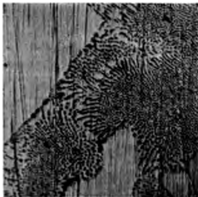
Fig. 1. 10,3 Atomproz. Mn - 89,7 Atomproz. Sb. 180fache Vergröß., geätzt mit FeCl 3 Lösung.
