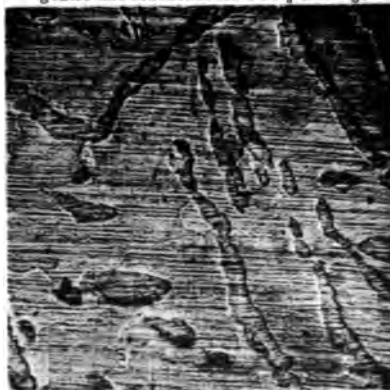
Fig. 6. 59,8 Atomproz. Sb — 40,2 Atomproz. Sn. 36 Stunden auf 400° exponiert, 24fache Vergr., geätzt mit alkoholischer FeCl 3 Lösung.
