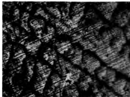
Fig. 2. 60% Pt + 40% Fe Geätzt mit Königswasser 70fache Vergrößerung.
