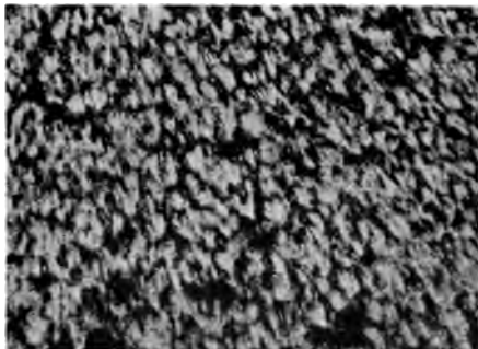
Fig. 15. Aluminothermisch hergestellt 73,4% Mo, 26,3% Fe. Geätzt mit Königswasser. 80fache Vergrößerung.
