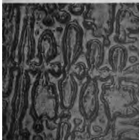
11. 4,99% Si + 95,01% Cu. Normal abgekühlt. 68fache Vergrößerung. Geätzt mit \text{HNO}_3 .
