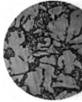
Fig. 15. 55% Sn, gewöhnlich abgekühlt. 68fache Vergrößerung. Geätzt mit HCl.
