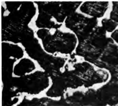
Fig. 5. 50% Fe + 50% Sn, untere Schicht. 180fache Vergrößerung. Geätzt mit HNO 3 , 1 : 20.
