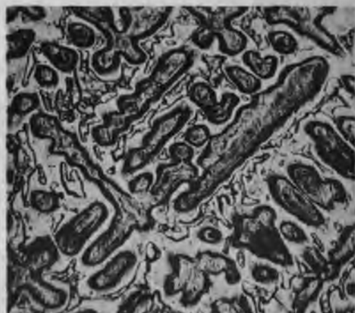
Fig. 10. 6,12% Si + 93,88% Cu. Normal abgekühlt. 68fache Vergrößerung. Geätzt mit \text{HNO}_3 .
