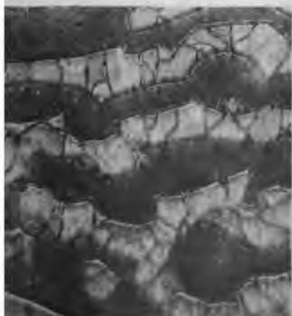
14% Si + 92,66% Cu. 5 Stunden auf 800° erhitzt, abgeschreckt. 300fache Vergrößerung. Geätzt mit HNO 3 .
