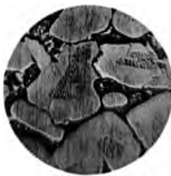
Fig. 11. 45% Sn, gewöhnlich abgekühlt. 200fache Vergrößerung. Geätzt mit NH_3 + H_2O_2 .
