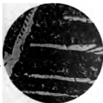
Fig. 16. 90% Sn, gewöhnlich abgekühlt. 68fache Vergrößerung. Geätzt mit verdünnter HCl.
