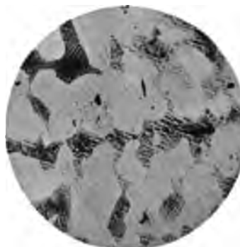
Fig. 17. 25% Sn, nach langsamer Abkühlung abgeschreckt bei 480^\circ . 68fache Vergrößerung. Geätzt mit NH_3 + H_2O_2 .
