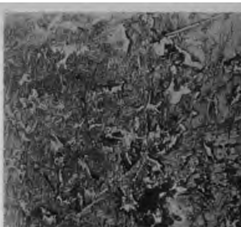
Fig. 2. 19,58% Si + 80,42% Cu. Normal abgekühlt. 68fache Vergrößerung. Geätzt mit HNO 3 .
