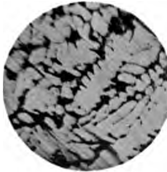
Fig. 14. 50% Sn, langsam abgekühlt. 68fache Vergrößerung. Geätzt mit HCl.
