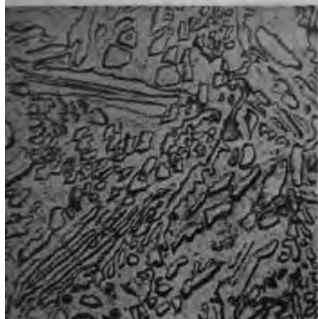
7. 7,58% Si + 92,42% Cu. Normal abgekühlt. 68fache Vergrößerung. Geätzt mit \text{HNO}_3 .
