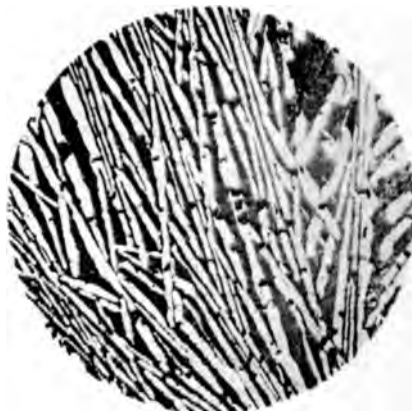
Fig. 8. 35% Au. + 65% Sn. 25fache Vergrößerung. Geätzt mit conc. HNO 3 .
