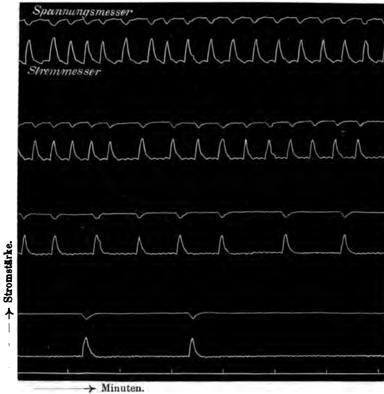
Fig. 1. Gleichzeitige Registrierung der Klemmspannung und der Stromstärke.
