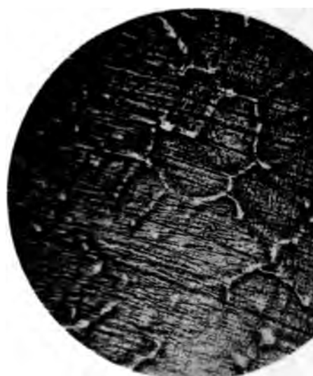
Fig. 4. 3% Al. + 97% Ag. 110 fache Vergrößerung.
