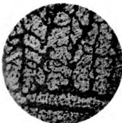
Fig. 8. 36,00% Tl. + 64,00% Mg. 40fache Vergrößerung.
