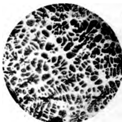
Fig. 4. 70% Au. + 30% Sn. 80fache Vergrößerung. Geätzt mit Königswasser.
