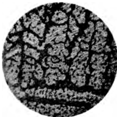
Fig. 8. 36,00% Tl. + 64,00% Mg. 40 fache Vergrößerung.
