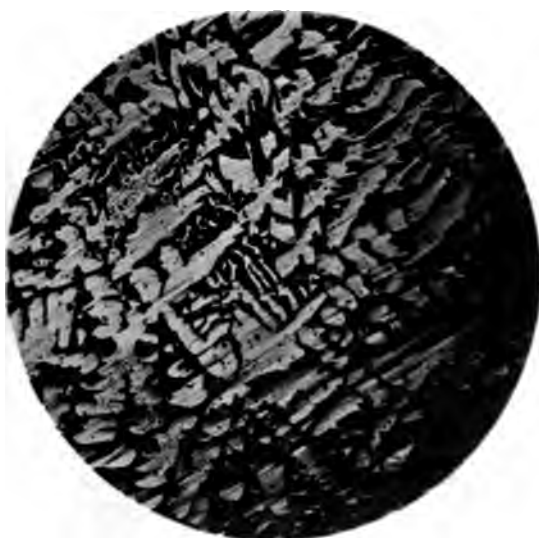
Fig. 3. 6% Al. + 94% Ag. 30 fache Vergrößerung.
