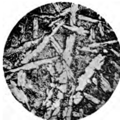
Fig. 11. 15% Au. + 85% Sn. 25fache Vergrößerung. Geätzt mit conc. HNO 3 .
