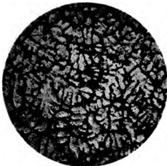
Fig. 1. 90% Al. + 10% Ag. 30 fache Vergrößerung.
