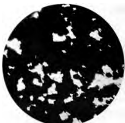
Fig. 10. 45,52% Tl. + 54,48% Mg. 50 fache Vergrößerung.
