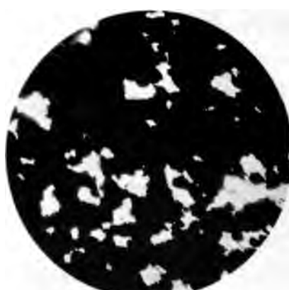
Fig. 10. 45,52% Tl. + 54,48% Mg. 50fache Vergrößerung.
