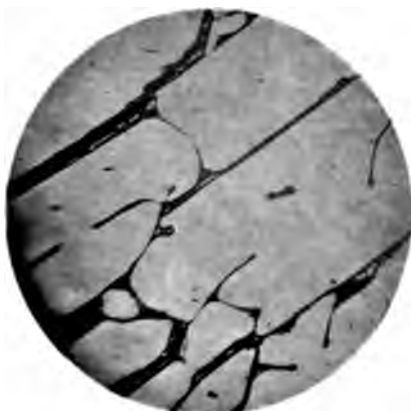
Fig. 7. 45% Au. + 55% Sn. 50fache Vergrößerung. Geätzt mit conc. HNO 3 .
