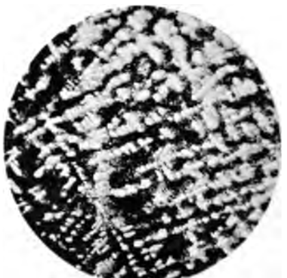
Fig. 6. 15% Gold + 85% Zink. 22fache Vergrößerung. geätzt mit concentr. HNO 3 .
