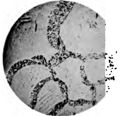
Fig. 4. 55% Gold + 45% Zink. 20fache Vergrößerung. geätzt mit concentr. HNO 3 .
