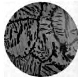
Fig. 6. 52,5% Zn. geätzt mit verd. HNO_3 , langsam abgekühlt. 22 fache Vergrößerung.
