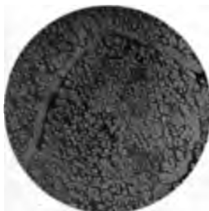
Fig. 5. 45% Zn. geätzt mit verd. HNO_3 , langsam abgekühlt. 22 fache Vergrößerung.
