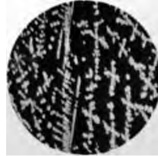
Fig. 8. 95% Zn. geätzt mit verd. HNO_3 , langsam abgekühlt.
