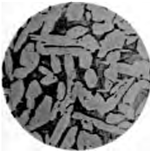
Fig. 3. 28,1% Zn. geätzt mit verd. HNO_3 , langsam abgekühlt. 65 fache Vergrößerung.
