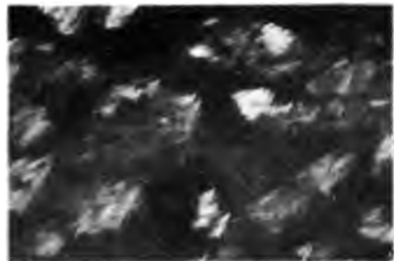
Fig. 6. 30 Gew.-Proz. Pt + 70 Gew.-Proz. Pb 80fache Vergrößerung.
