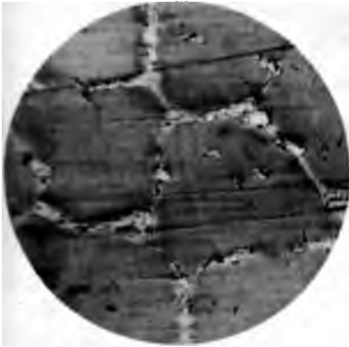
Fig. 3. Nr. 85. 35% Pb, 35% Sn, 30% Mg 180fache Vergrößerung.
