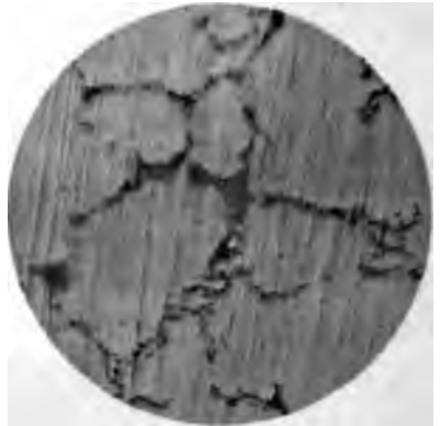
Fig. 6. Nr. 79. 15% Pb, 15% Sn, 70% Mg 180fache Vergrößerung.
