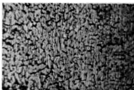
Fig. 2. 30 Gew.-Proz. Pt + 70 Gew.-Proz. Cu 80fache Vergrößerung.
