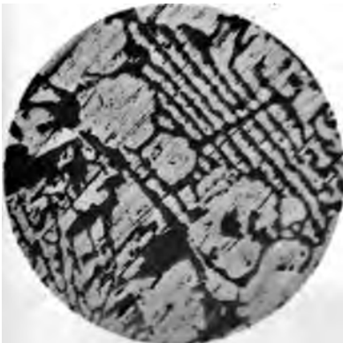
Fig. 5. Nr. 82. 25% Pb, 25% Sn, 50% Mg 180fache Vergrößerung.
