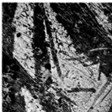
Fig. 3. 75% Te + 27% Cu 68 fache Vergrößerung.
