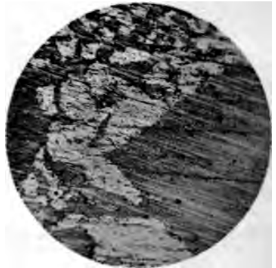
Fig. 4. Nr. 90. 45% Pb, 15% Sn, 40% Mg 180fache Vergrößerung.
