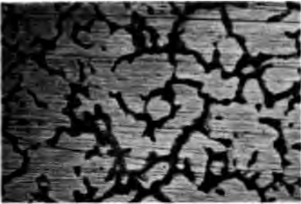
Fig. 1. 10 Gew.-Proz. Pt + 90 Gew.-Proz. Au 80fache Vergrößerung.
