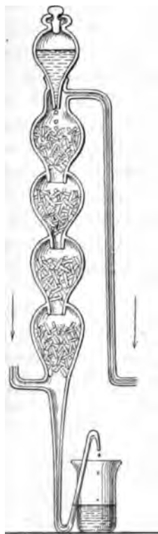
Fig. 3. Turm, wie er zum Trocknen der Gase angewandt wurde.
