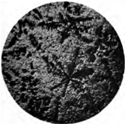
Fig. 5. 70% Mg. + 30% Al. 40fache Vergrößerung.
