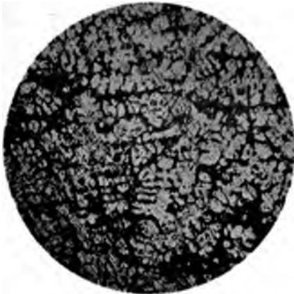
Fig. 1. 20% Mg. + 80% Al. 40fache Vergrößerung.
