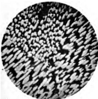
Fig. 5. 25% Gold + 75% Blei. 70fache Vergrößerung.
