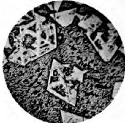
Fig. 4. 15% Gold + 85% Blei. 70fache Vergrößerung.
