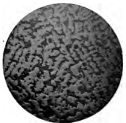
Fig. 4. 60% Mg. + 40% Al. 40fache Vergrößerung.
