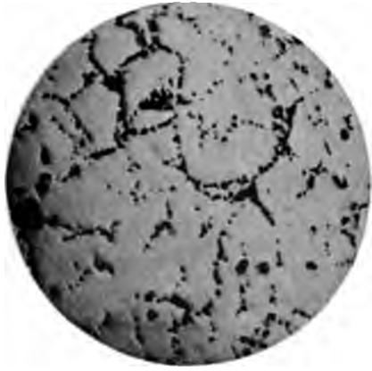
Fig. 3. 55% Mg. + 45% Al. 40fache Vergrößerung.
