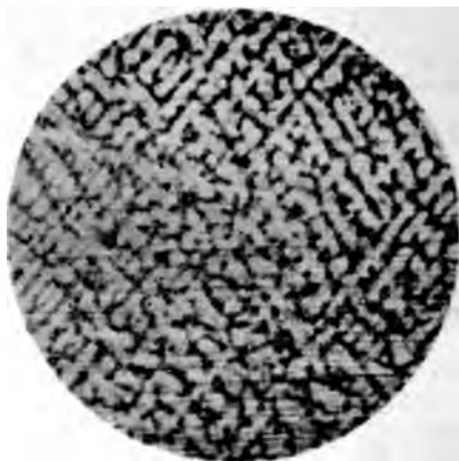
Fig. 2. 70% Eisen + 30% Mangan. 40fache Vergrößerung.
