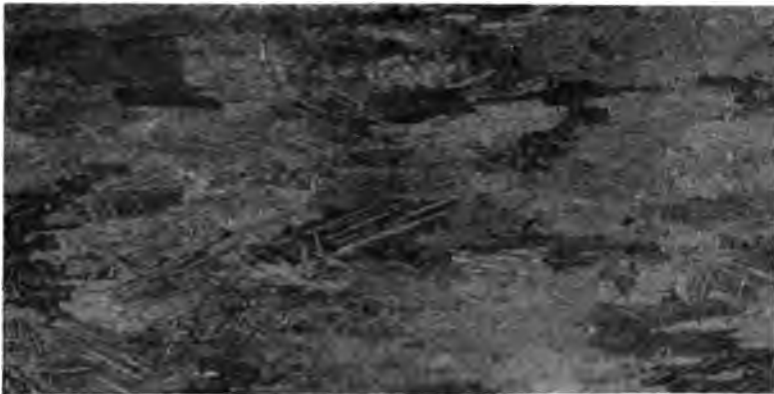
Fig. 2. Mikrophotographische Aufnahme der Ätzfläche des auf 270° erhitzten reinen Elektrolytzinks. (Vergrößerung 40 fach.)
