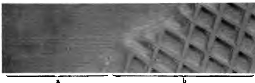
Fig. 2. a) Streifenförmige Struktur infolge ungleichmäßiger Legierung eines mit 0.2 % Kadmium legierten Elektrolytzinks.
