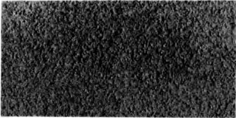
Fig. 1. Mikrophotographische Aufnahme der Ätzfläche des bei 120° gewalzten mit 0.4% Kadmium legierten Elektrolytzinks. (Vergrößerung 40 fach.)
