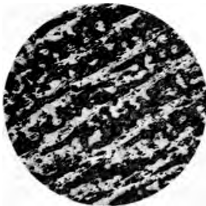
Fig. 3. 50% Eisen + 50% Mangan (schnell abgekühlt). 100fache Vergrößerung.
