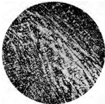
Fig. 1. 40% Eisen + 60% Mangan. 40fache Vergrößerung.
