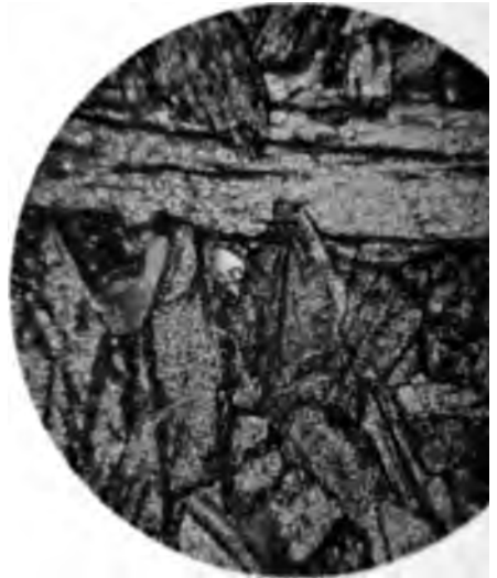
Fig. 2. 61,6% PbO + 88,4% PbCl 2 , entsprechend der Verbindung PbCl 2 · 2PbO 80 fache Vergrößerung.
