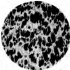
Fig. 3. 80% Cd. 20% Mg. 50 fache Vergrößerung.
