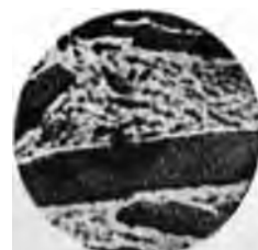
Fig. 8. 90% Sb. 10% Mg. 100 fache Vergrößerung.
