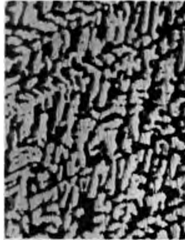
Fig. 4. 69 Atomproc. Cd. + 31 Atomproc. Cu. 25 fache Vergrößerung.
