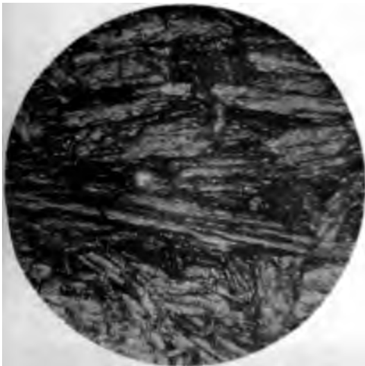
Fig. 3. 64% PbO + 86% PbCl 2 . 80 fache Vergrößerung.
