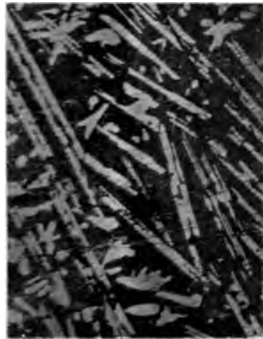
Fig. 2. 42 Atomproc. Cd. + 58 Atomproc. Cu. 25 fache Vergrößerung.
