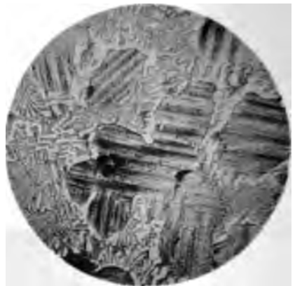
Fig. 6. 50,4% Ni. + 49,6% Sb. 190fache Vergrößerung. Geätzt mit HNO_3 .
