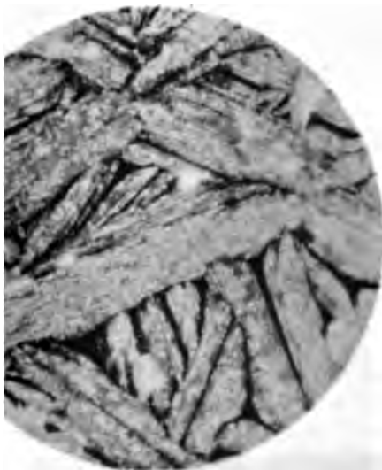
Fig. 7. 80% PbO + 20% PbCl 2 . 30 fache Vergrößerung.
