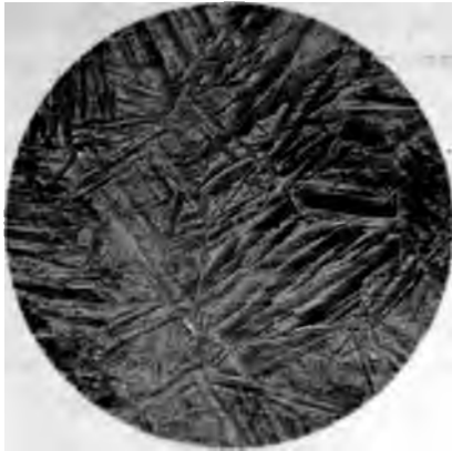
Fig. 7. 55,12% Ni. + 44,88% Sb. Bei gewöhnlichen Bedingungen abgekühlt. 65fache Vergrößerung. Geätzt mit HNO 3 .
