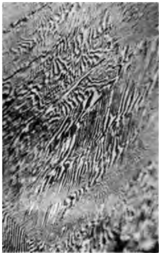
Fig. 3. 10 Atomproc. Cd. + 54,6 Atomproc. Cu. 200 fache Vergrößerung.
