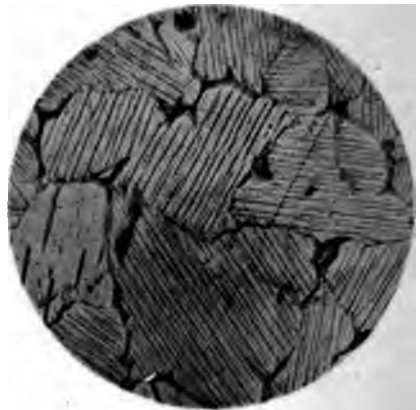
Fig. 4. 41,5% Ni. + 58,5% Sb. 65fache Vergrößerung. Geätzt mit HNO_3 .
