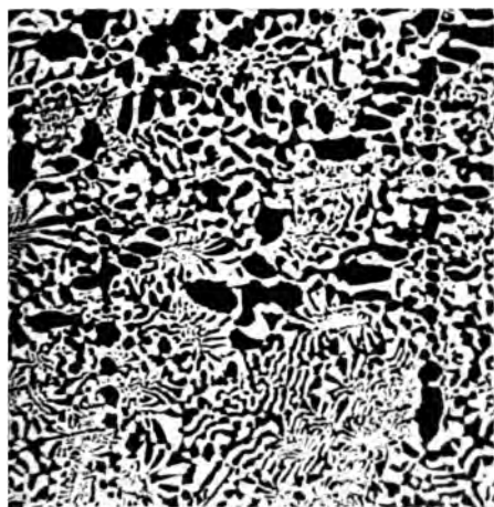
Fig. 3. Si. = 20,2 Atompr., Ni. = 79,8 Atompr., 70fache Vergrößerung.
