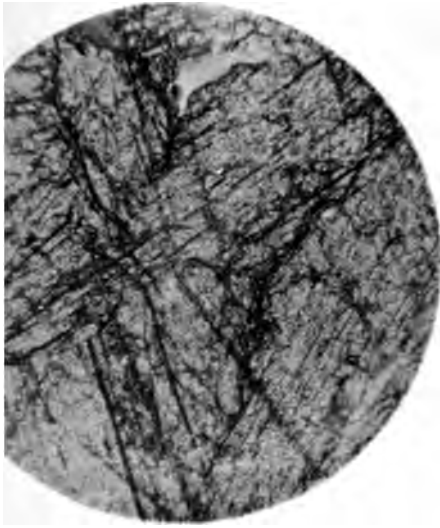
Fig. 5. 72% PbO + 28% PbCl 2 . 30 fache Vergrößerung.
