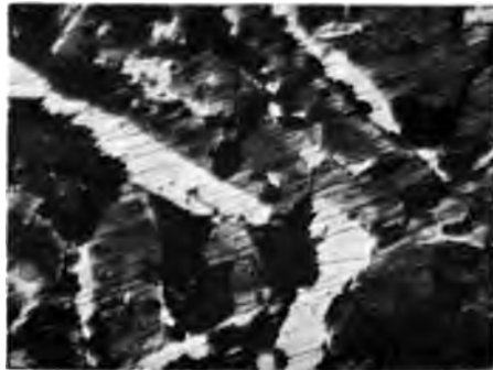
Fig. 6. 50 Gew.-Proz. Mn + 50 Gew.-Proz. Si. 80fache Vergrößerung.
