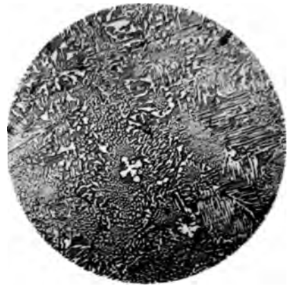
Fig. 4. 75% Gold + 25% Antimon. 70fache Vergrößerung. Geätzt mit NaOH.
