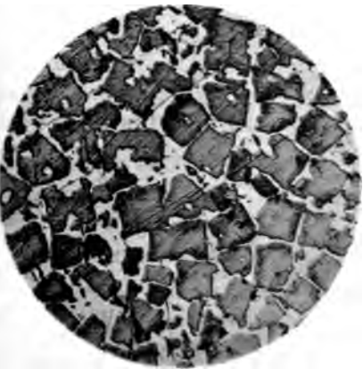
Fig. 5. 60% Gold + 40% Antimon. 70fache Vergrößerung. Geätzt mit NaOH.
