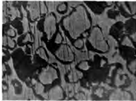
Fig. 4. 40 Gew.-Proz. Mn + 60 Gew.-Proz. Si. 80fache Vergrößerung.
