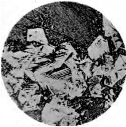
Fig. 1. 30% Gold + 70% Wismut. 27fache Vergrößerung. Geätzt mit Königswasser.
