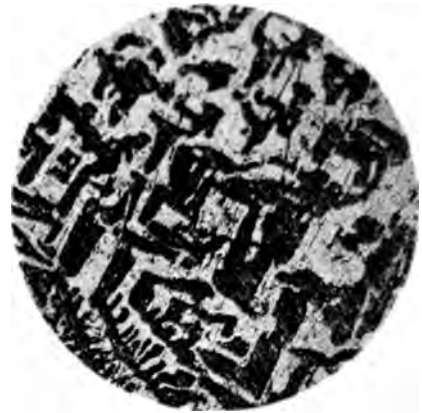
Fig. 2. 15% Gold + 85% Wismut. 27fache Vergrößerung. Geätzt mit Königswasser.
