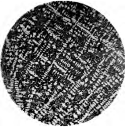
Fig. 3. 80% Gold + 20% Antimon. 27fache Vergrößerung. Geätzt mit NaOH.
