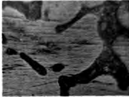
Fig. 2. 15 Gew.-Proz. Mn + 85 Gew.-Proz. Si. 450fache Vergrößerung.
