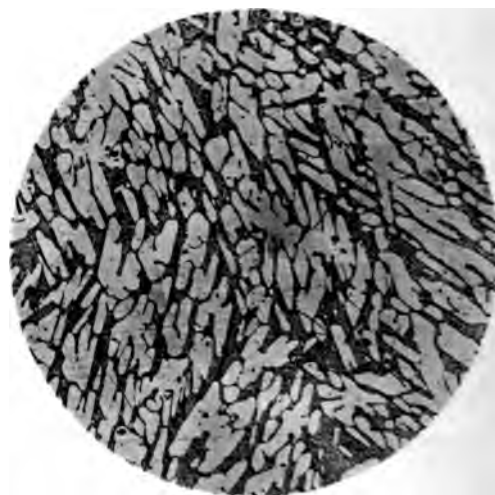
Fig. 2 35% Sb, geätzt mit verd. \text{HNO}_3 , 30fache Vergrößerung.
