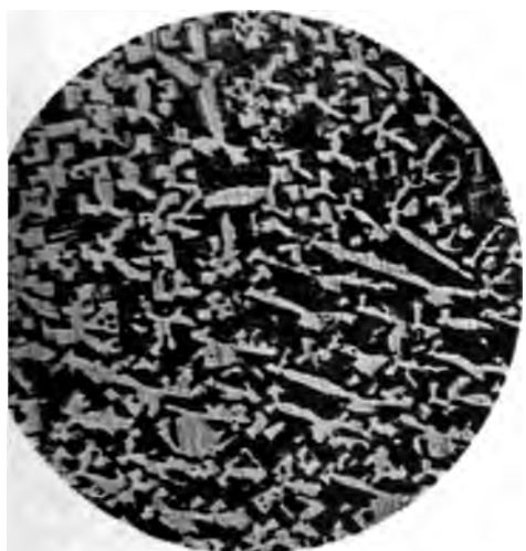
Fig. 3. 70% Sb, geätzt mit verd. \text{HNO}_3 , 30fache Vergrößerung.
