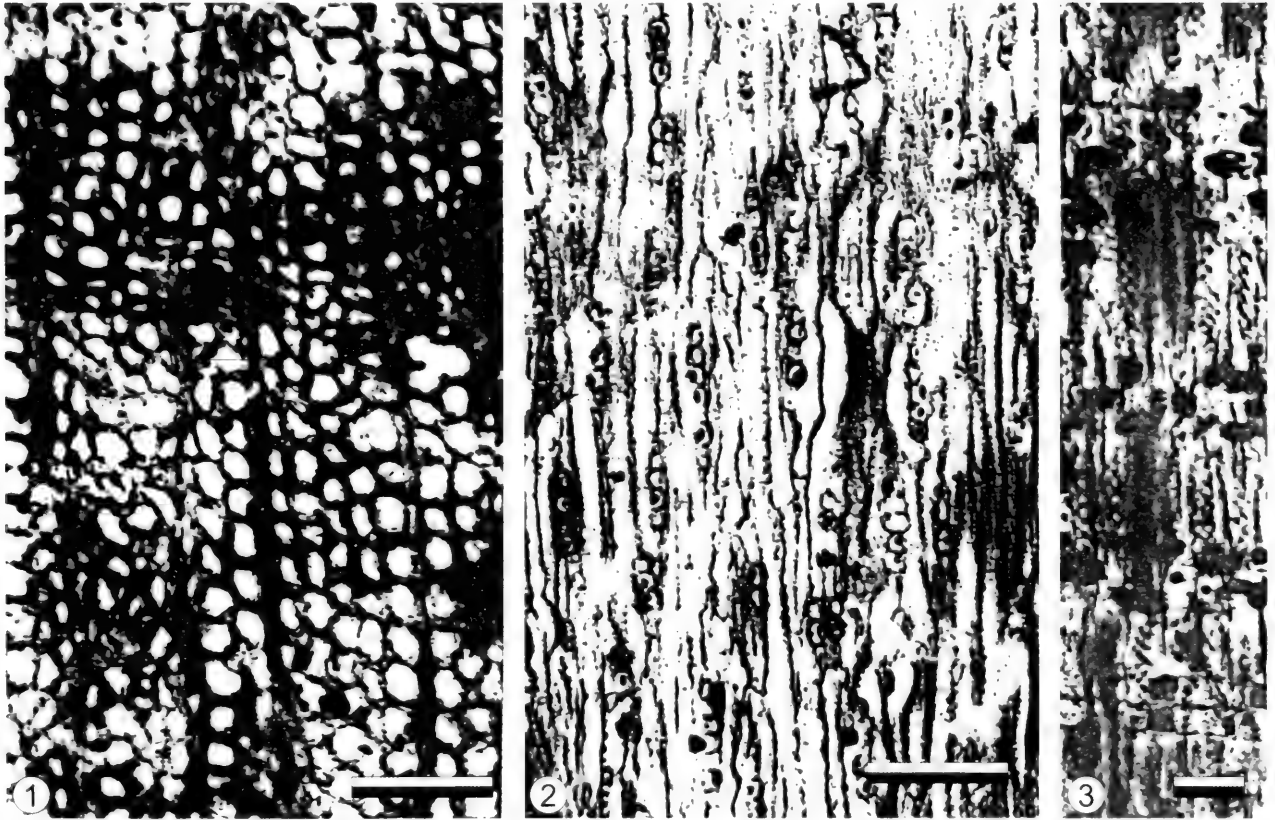
1 横切面, 生长轮明显, 早材至晚材渐变, 标尺60 \mu\text{m} ; 2 弦切面, 示单列射线, 标尺60 \mu\text{m} ; 3 径切面, 示射线形态, 标尺40 \mu\text{m}
