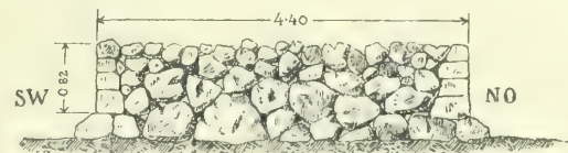
Fig. 27 Querprofil des Straßendamms in Hardomilje-Smokovice.
