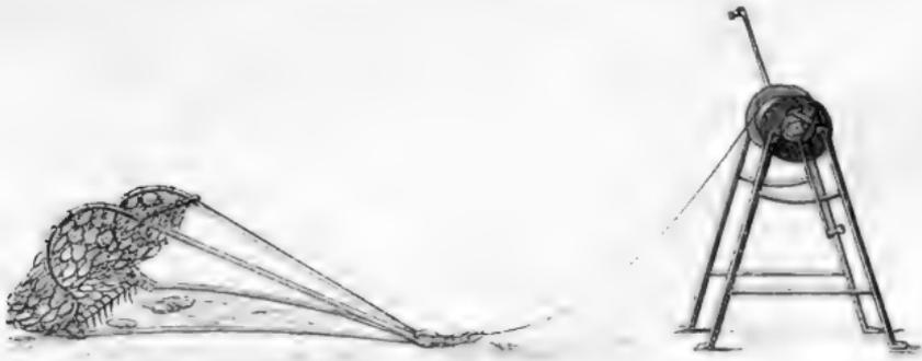
Fig. 130. Modell eines Austernfangnetzes mit Winde.
