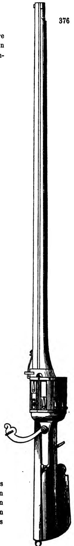
Zündloch liegt in der Mitte des Kopfes der oben schüsselartig gebildeten Stange. Auf der zweiten beiliegenden Tafel ist diese Röhre nebst Durchschnitt des Verschlussmechanismus als Fig. 9 u. 10 abgebildet.
