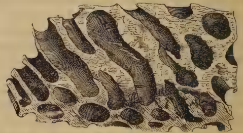
Holz vom Pfahlwurm durchbohrt.
