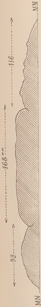
Fig. 5. Coupe suivant MN, MN de l'épanchement boueux représenté dans la fig. 3. On y voit la masse médiane reposant sur un matelet boueux qui se dispose à droite et à gauche sous la forme de plèvres immobiles.
