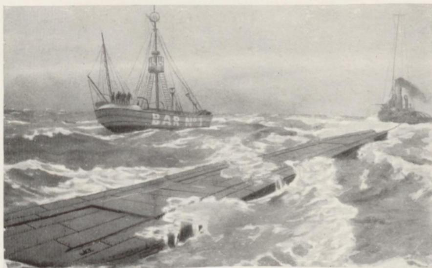
Englisches Projekt, tiefgehende und ganz flach gebaute Leichter ohne Besatzung zum Transport von Kriegsmaterial zu verwenden, um so der U-Boots-Gefahr und des eigenen Personal-mangels Herr zu werden. Diese Leichter sollten von bewaffneten Schleppdampfern durch das Kriegsgebiet geschleppt werden
