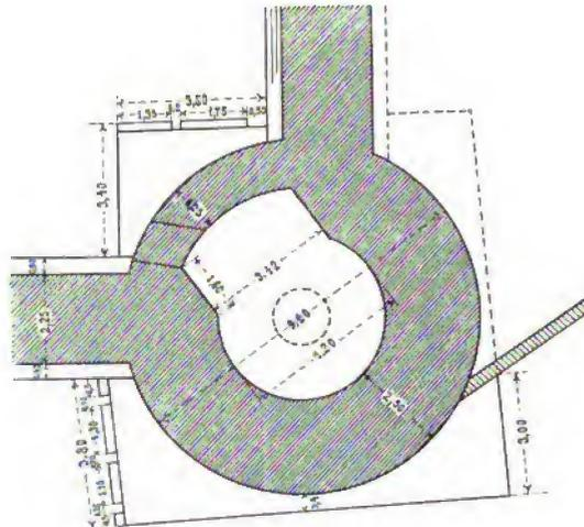
Fig. 64. Köln. Grundriss des sog. Römerturmes.
