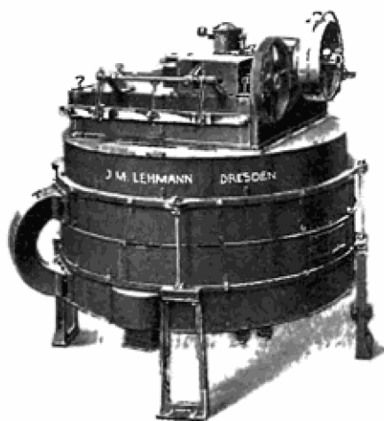
Abb. 103. Kakaopulver-Kühlmaschine von J. M. LEHMANN, Dresden-A.
