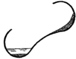
Abb. 314. Krystallisierwiege der I. G., D. R. P. 450 911 (Allein-Lizenz E. PASSBURG & B. BLOCK, G. M. B. H.).
