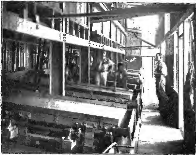
Abb. 7. Anlage von Amalgamiertischen mit Schüttelbewegung auf der Goldhütte der ABBONTIAKON BLOCK I LTD., Tarkwa, Goldküste,
