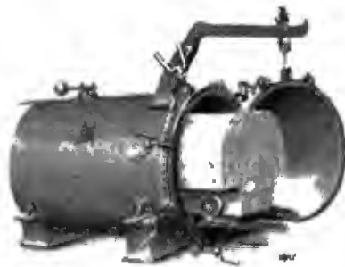
Abb. 283. Liegender Autoklav von R. HLIKL, Hohenschonhausen-Berlin.
