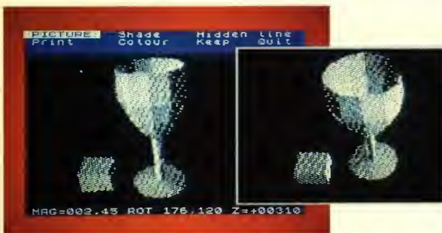
Bild 2. Automatisch schattiert das Programm die Figur, wenn die Beleuchtungsrichtung angegeben wird. Außerdem kann die Figur beliebig gekippt und gedreht werden.
