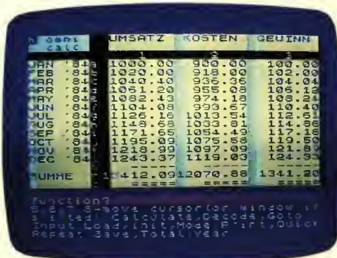
Bild 4. Dezimalwerte können auch als Dezimalzahlen mit zwei Stellen hinter dem Komma dargestellt werden. Alle möglichen Funktionen sind ebenfalls sichtbar.
