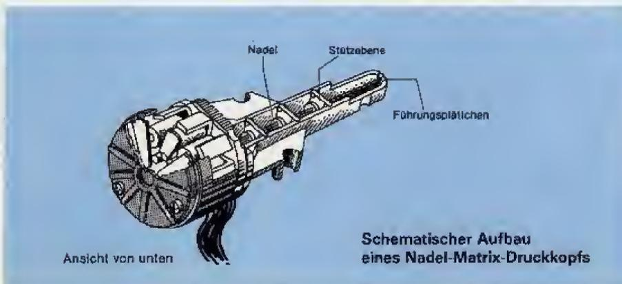
Schematischer Aufbau eines Nadel-Matrix-Druckkopfs
