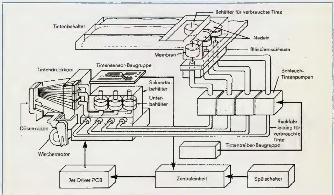
Schematischer Aufbau eines Farb-Tintendruckermechanismus
