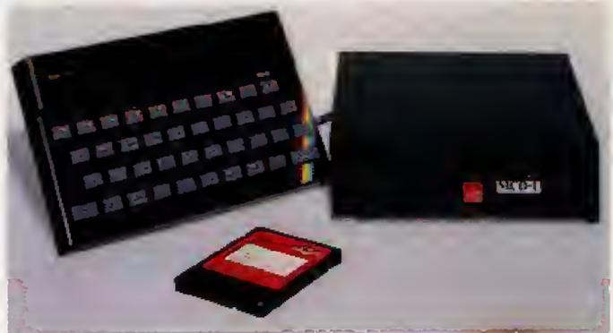
für ein Menü-Programm nutzen. Das Diskettensystem kann parallel zu jedem Druckerinterface (also auch mit einem Centronics-parallelen) ohne »Kollision« betrieben werden. Das Interface des Laufwerkes belegt automatisch die Basic-Programmzeile 0 mit einer Länge von 56 Byte. Diese Zeile implementiert
