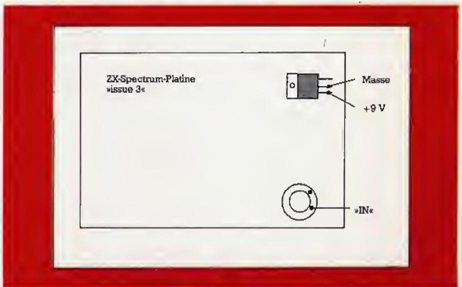
Bild 3a. Anschluß im Computer mit »issue three«-Platine
