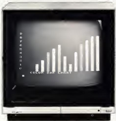
**CD 3195 Multi-Funktions-Monitor, PAL-Color-Monitor, 36 cm Diagonale, Bildröhre mit 0,6 mm dot pitch Abstand, Video-Composite und Audio-Eingang, eingebauter 2-Watt-Verstärker, Grünschalter für augenschonende Textdarstellung.**
