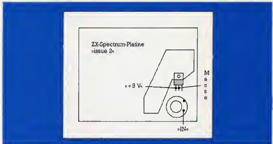
Bild 3. Anschluß im Computer mit »issue two«-Platine
