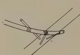
Fig. 131. Befestigung der vorderen Auslegerstange.
