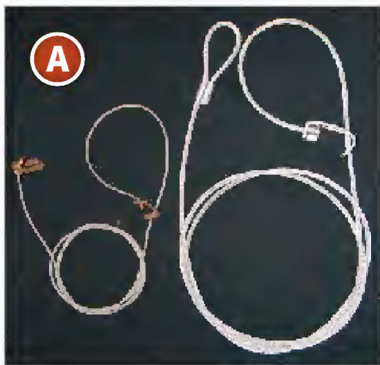
Figura 5.4. Lazos de acero de 2 calibres: (A) de 1/8" resistente hasta 200 Kg/150Kg bajo tensión (extrema izquierda) y de 1/4" resistente hasta 500 Kg/400 Kg bajo tensión (en medio). (B) Ampliación del lazo de menor calibre. (C) Ampliación del lazo de mayor calibre.
