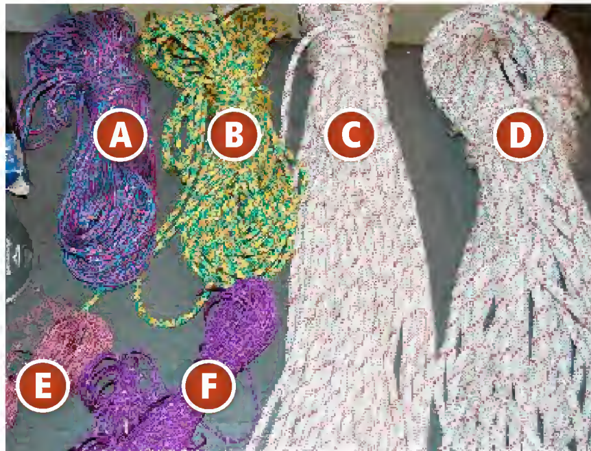
Figura 5.3. Cuerdas de manejo para cocodrilos (A) Cordón de 5 mm/150 Kg. (B) Cordón de 7 mm/300 kg. (C) Cuerda Estática de 9 mm/500 kg. y (D) Cuerda estática de 11 mm/1000 kg) (E) Cordino de 2 mm/50 kg. (F) Cordón de 3 mm/100 kg.. Fotografía: J. Domínguez-Laso
