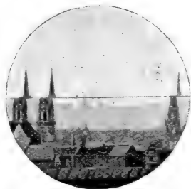
Fig. 5 Gesichtsfeld des Koinzidenz-Entfernungsmessers.
