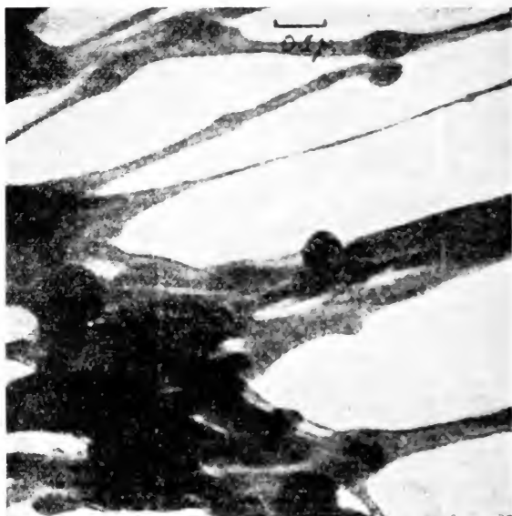
FIG. 17. — Cloruro de vinile escasamente polimerizado (aumento 77.000 diámetros). De Trans. El. Eng. , 1941, pág. 161.
