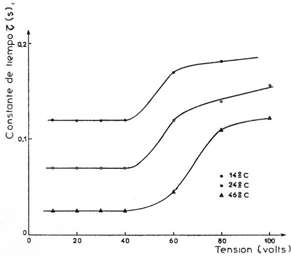
Fig. 6. — Variación de la constante de tiempo  $\tau$  en función de la tensión para varias temperaturas, en una célula de 13  $\mu\text{m}$ .
