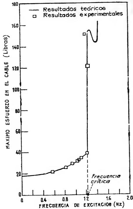
Fig. 11. — Esfuerzo máximo total en el extremo superior de un cable de acero de  $1/16''$  en función de la frecuencia de excitación (Referencia 16)
