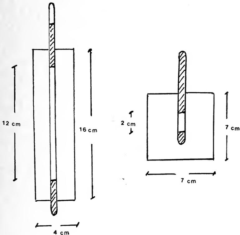
Fig. 1. — Probetas prismática y cúbica
