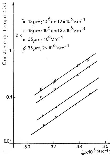
Fig. 3. — Variación de la constante de tiempo  $\tau$  en función de la temperatura con campos eléctricos constantes ( $10^6$  y  $2 \times 10^6$  Vm<sup>-1</sup>) para células de tres espesores (13, 18 y 35 μm)
