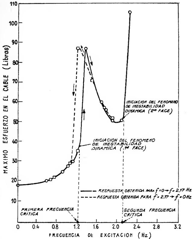
Fig. 13. — Esfuerzo máximo total en el extremo superior de un sistema segmentado de cables vibrando en agua : comparación de resultados y experimentales (Referencia 16)
