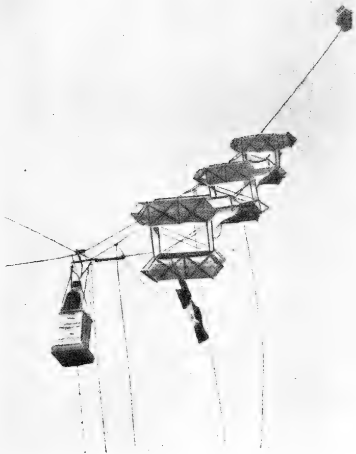
Fig. 10. — Tren de cometas sustentando una barquilla tripulada
