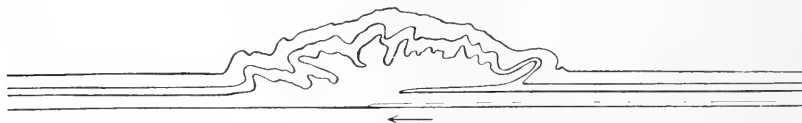
Fig. 12. — Una capa de arena seca entre dos capas de arena poco húmeda. Plegadura inclinada hacia ambos lados
