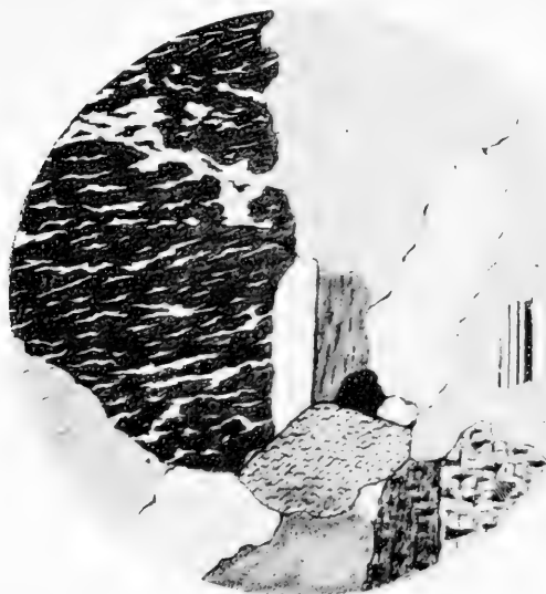
Granítica hornblendífera : cantera de López Lecube (dibujo a cámara clara; nicoles cruzados). Toda la parte superior del campo está ocupada por ortosa micropertítica (a la izquierda hay una sección en posición de extinción, y a la derecha una que incluye un cristal maclado de oligoclasa); en la parte inferior y derecha se ve un microclino micropertítico; más adentro, una sección transversal de hornblenda; los granos blancos son de cuarzo.
