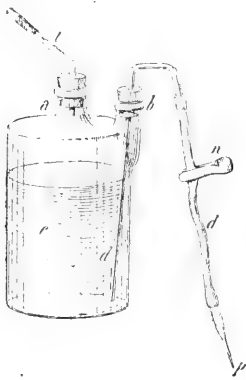
Fig. 1658. — Conserve de bouillon stérilisé. — t , tubulure ouverte, à étranglement, et avec tampon d'ouate ; d, d , siphon ; n , pince ; p , ajustage de verre fermé.
